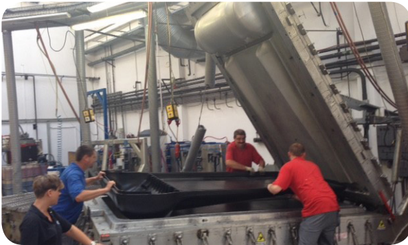
Die Tinby A/S hat Erfahrung mit dem Polyurethanguss sehr großer Geometrien
